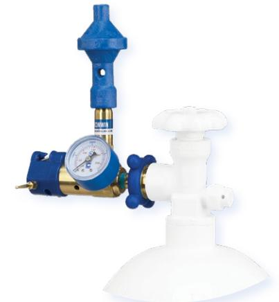
Reduktor z wyjściem typu Push mieszający 60/40 do balonów lateksowych. Z wyjścia tego typu wydobywa się mieszanina gazów: 60% helu oraz 40% powietrza. Pozwala to zaoszczędzić znaczną ilość helu podczas pompowania balonów lateksowych, jednocześnie zachowując zdolność balonów do unoszenia się.
