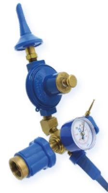
Reduktor z wyjściem typu Tilt (zginany) do balonów lateksowych oraz z wyjściem automatycznym do balonów foliowych i typu bubble. Dzięki wbudowanej membranie sterującej, automat samoczynnie odcina dopływ helu gdy balon jest optymalnie napęczniony.
