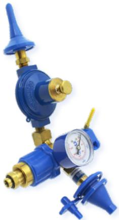
Reduktor z wyjściem typu Push (naciskany) do balonów lateksowych i bubbles oraz z wyjściem automatycznym do balonów foliowych i typu bubble. Dzięki wbudowanej membranie sterującej, automat samoczynnie odcina dopływ helu gdy balon jest optymalnie napęczniony.
